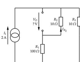
$$I_{R_2} = -I \cdot \frac{R_3}{R_1 + R_2 + R_3} \quad (1)$$
